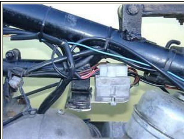
Regardez maintenant le module d'avance électronique ,vous pouvez y voir 4 petit interrupteurs qui vous permette de sélectionner la courbe d'avance désirée. A l'origine BMW règle l'avance à 9°-40° de 800-2500 tr/mn .
