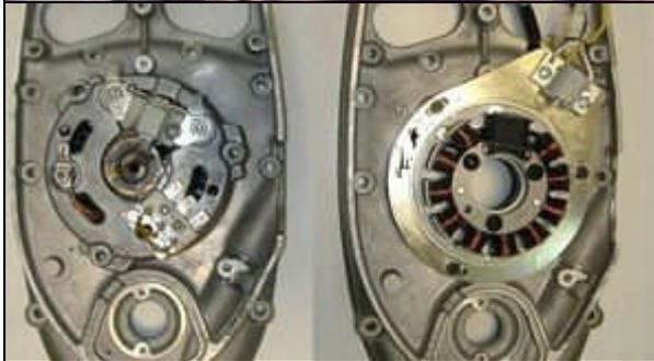
Installez la nouvelle plaque de base avec le stator à la place de votre alternateur.
