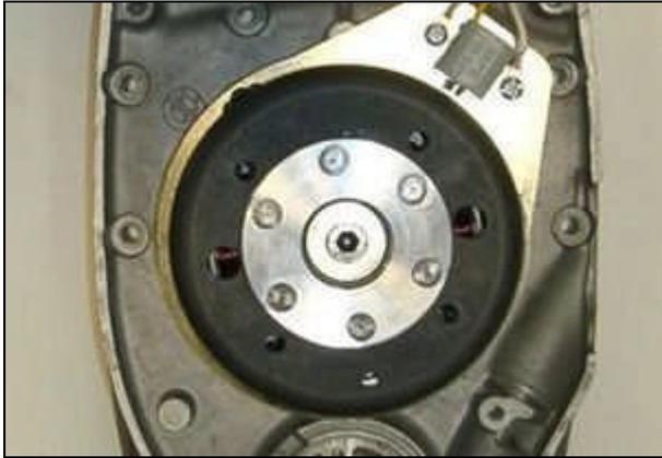
Enlevez la bougie. Installez le nouveau rotor sur le vilebrequin de manière à pouvoir tourner le moteur. Amenez le moteur sur la position FZ (visible dans le trou de réglage). Enlevez de nouveau le rotor sans changer la position du vilebrequin et replacez le de nouveau dans la position indiquée plus haut (1) .
