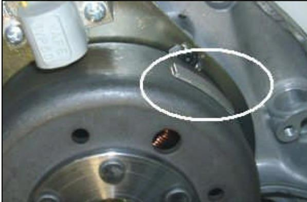
Regardez le nouveau rotor vous y verrez sur le pourtour une languette métallique rapportée ,c'est elle qui déclenche l'étincelle .Le système calcule automatiquement l'avance à l'allumage en fonction de la vitesse de rotation du moteur et la calcule en fonction du temps de passage de la languette devant le capteur
