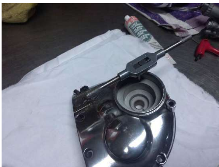
Décrochage des taraudages M4, M6 et M10x100 !
