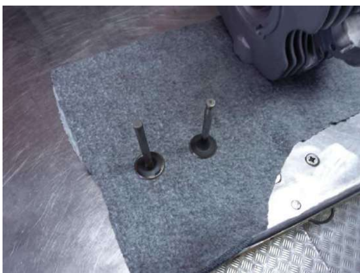
Nettoyage des soupapes. Adm : Ø29.5, Echap : Ø28 !
