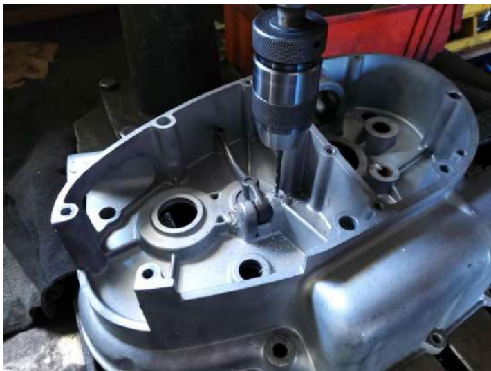
Microbillage et peinture du levier ! Axe bouffé et changé par un en inox verrouillé par une BTR M4.
