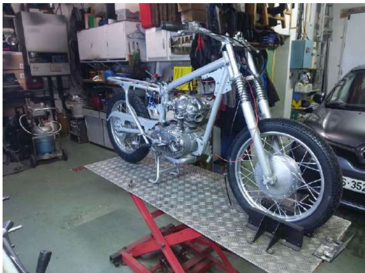
Remise en place du moteur dans la partie cycle. Serrage des six goujons M8 graissés : 2.5Kg.
