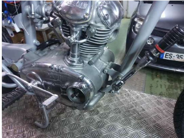
Remise en place du moteur dans la partie cycle. Serrage des six goujons M8 graissés : 2.5Kg.
