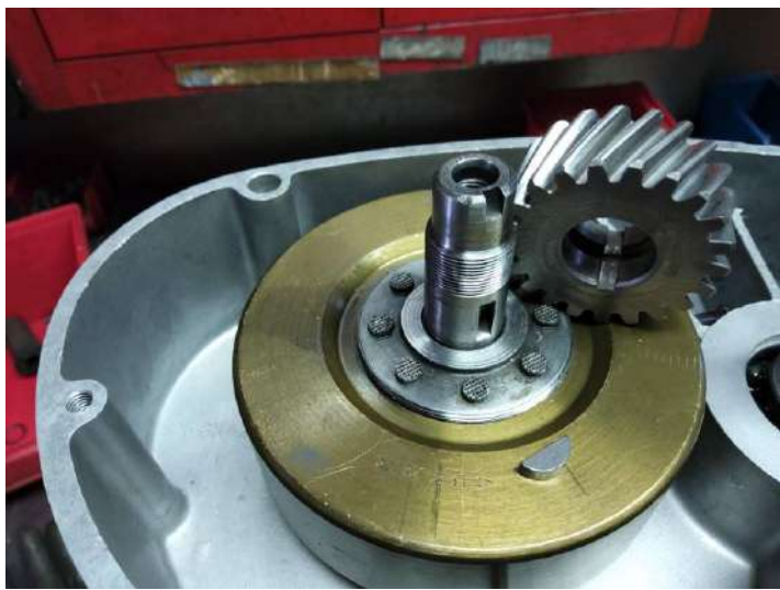
Clavette demi lune de 4 neuve. Serrage : 9Kg sur rondelle belleville + frein filet fort.
