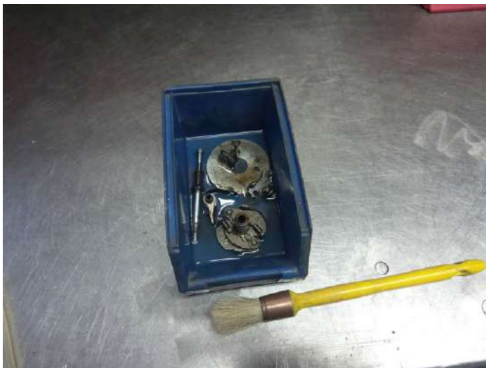
Avance centrifuge d'allumage AA 357B : dégraissage !
