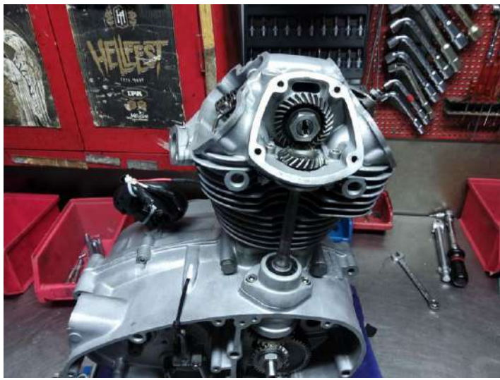
Calage du couple conique supérieur !
