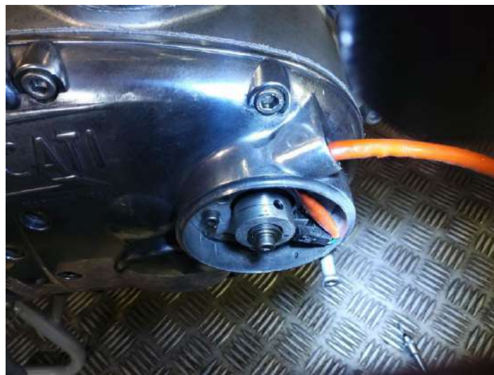
Calage du drapeau de déclenchement bien au centre du capteur !
