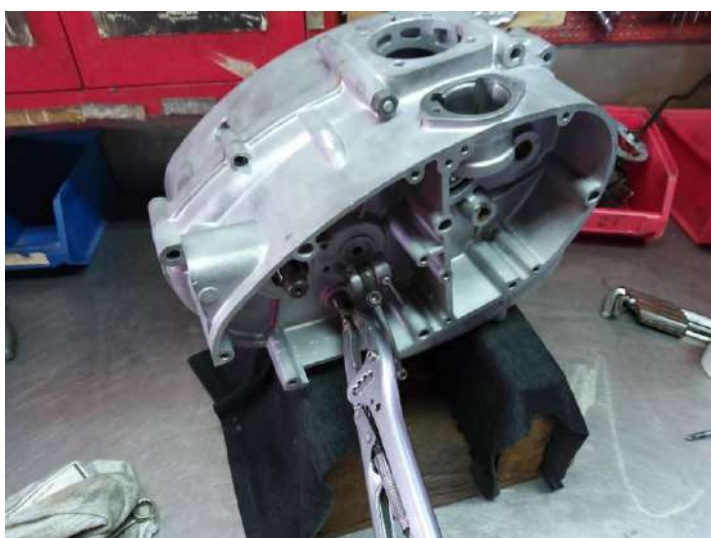
Re teste de passage des vitesses carters fermés sur joint papier de 0.70 !
