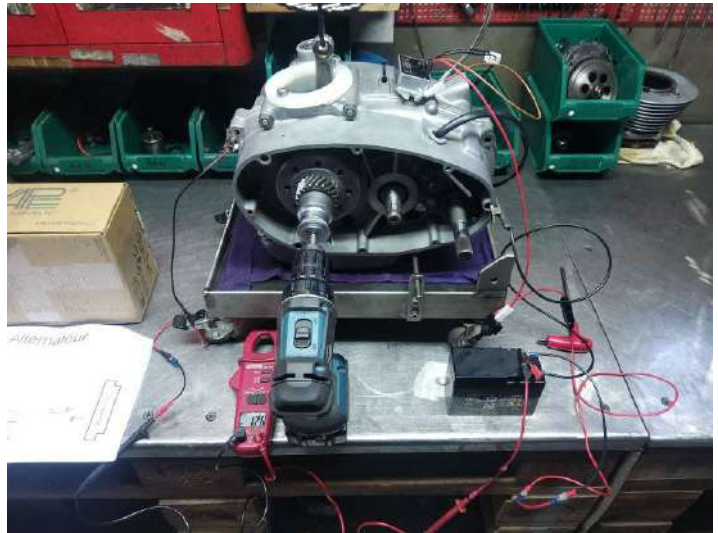
Teste à 2000tr/mn : 14V : impeccable !!!!!
