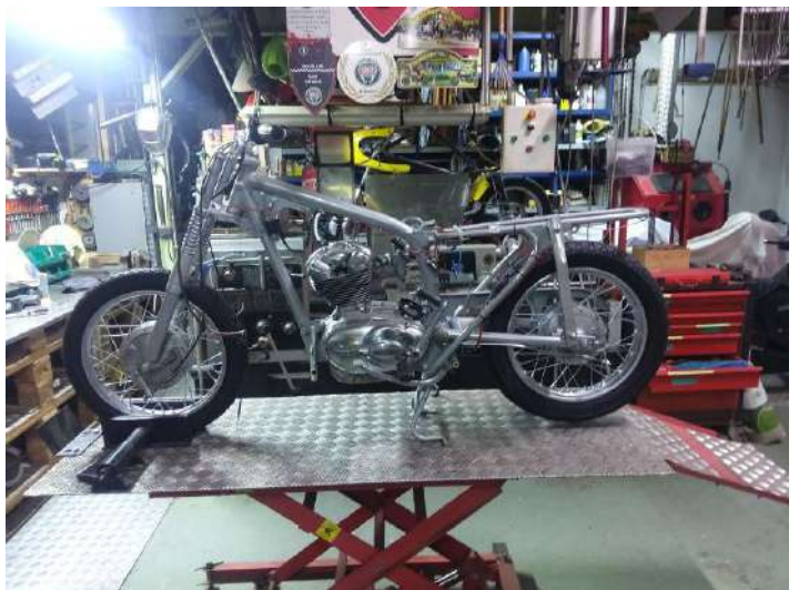
Remise en place du moteur dans la partie cycle. Serrage des six goujons M8 graissés : 2.5Kg.
