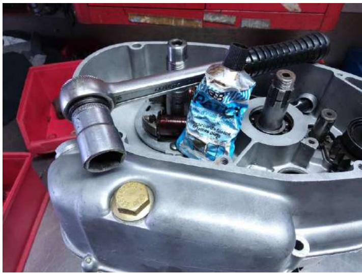
Montage de la crépine à l'oléoétanche. Remontage complet du système kick.
