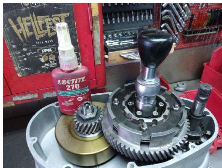
Serrage de la noix d'embrayage : 7Kg sur rondelle belleville + frein filet fort.
