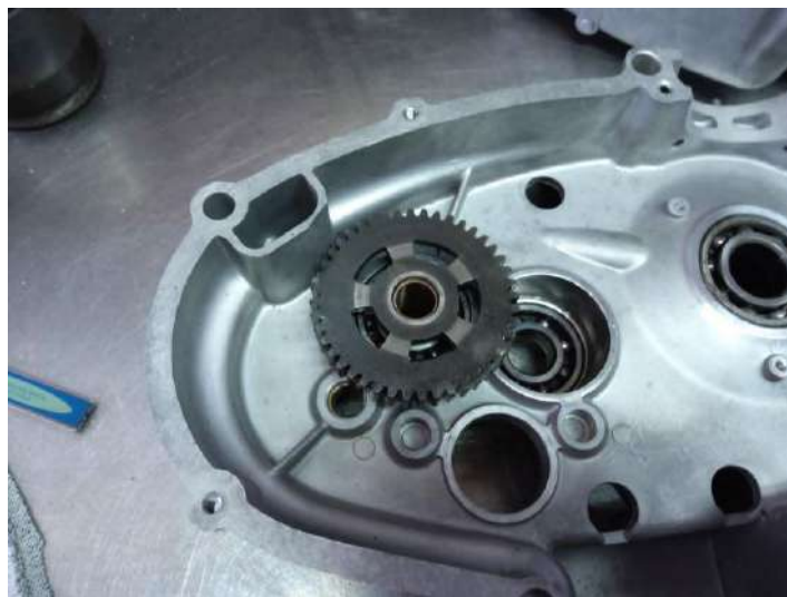
Toilage du pignon de première d'arbre secondaire qui sert au système kick, le roulement a été difficile à extraire au démontage.
