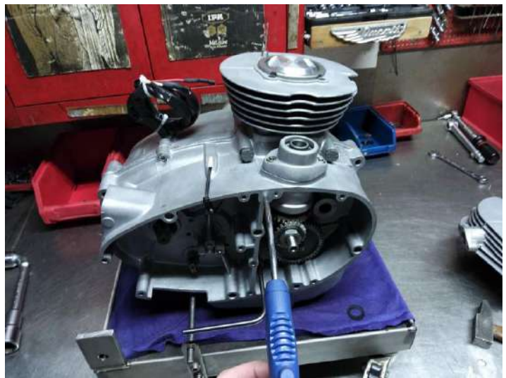
Montage du pion de centrage de la culasse et gicleur de montée d'huile Ø2 ! Contrôle du circuit de montée d'huile vers la culasse.
