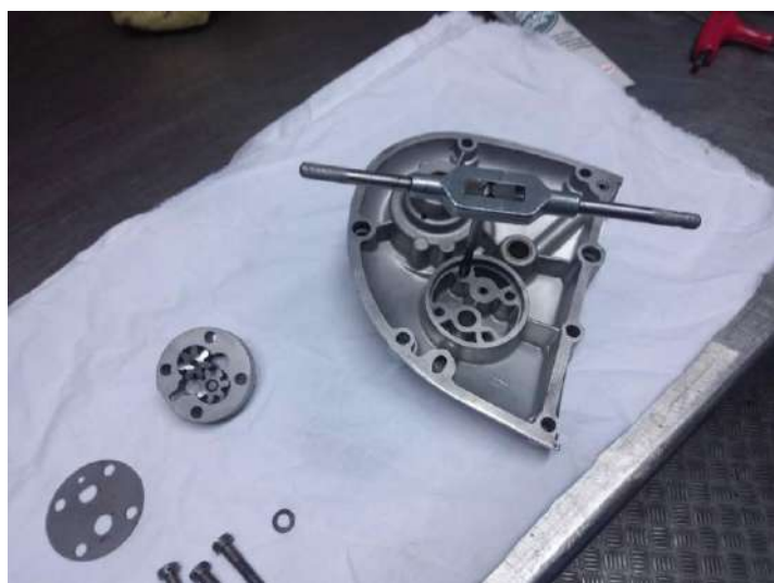
Décrochage des taraudages M4, M6 et M10x100 !
