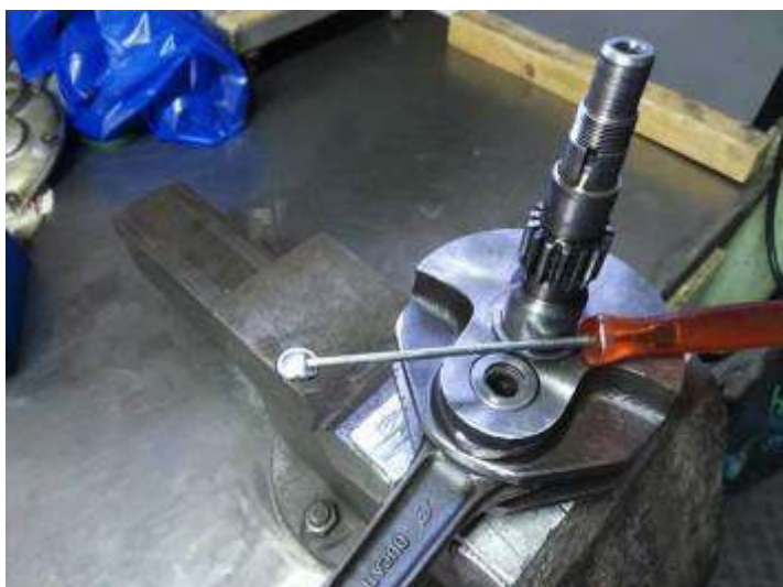
Extraction des pastilles de maneton pour le trouver bien encombré de crasse !
