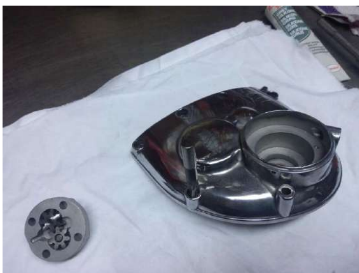
Décrochage de la pâte à polir dans les lamages.
