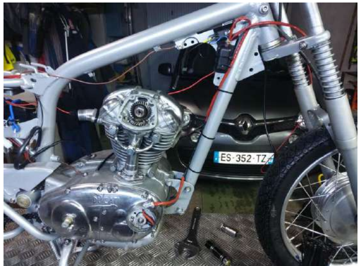
Préparation et montage du boîtier d'allumage !
