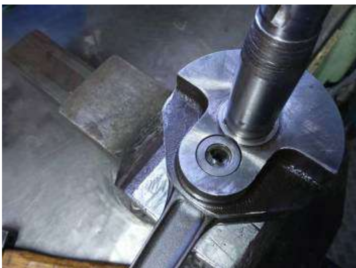
Extraction des pastilles de maneton pour le trouver bien encombré de crasse !
