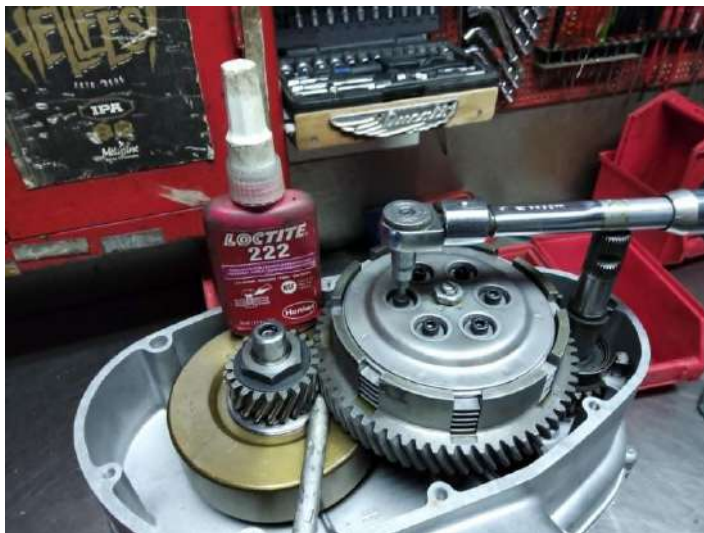
Les cinq disques garnis imbibés à l'huile moteur. Serrage des BTR M5x16 : 0.8Kg + frein filet faible.
