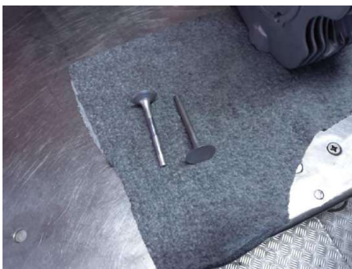
Nettoyage des soupapes. Adm : Ø29.5, Echap : Ø28 !
