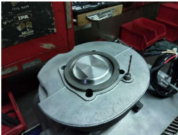
Montage du pion de centrage de la culasse et gicleur de montée d'huile Ø2 ! Contrôle du circuit de montée d'huile vers la culasse.
