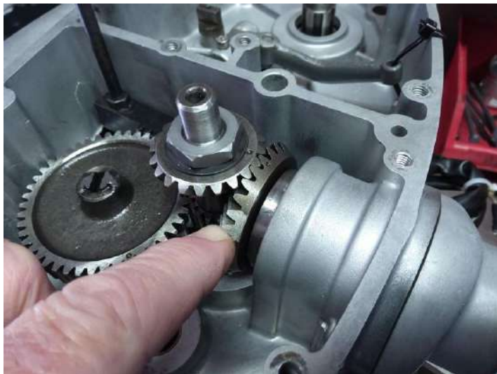
Calage du couple conique avec les pignons parfaitement alignés et un soupçon de jeu d'entre dents réglé à l'oreille !
