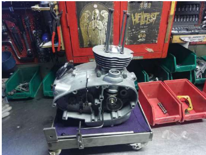
Remontage piston/cylindre sur joint d'embase de 0.90 !
