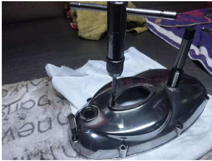
Décrochage des résidus de gomme de polissage.
