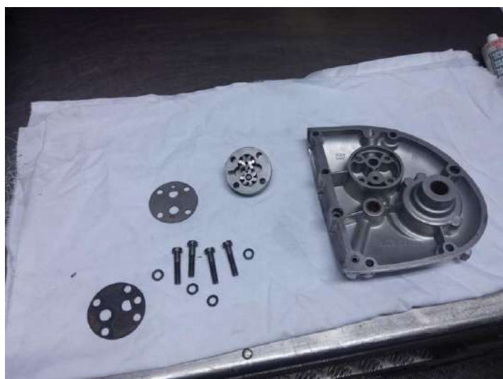
Remontage de la pompe à huile, teste de liberté de rotation et sécurisé les vis au fil à freiner !
