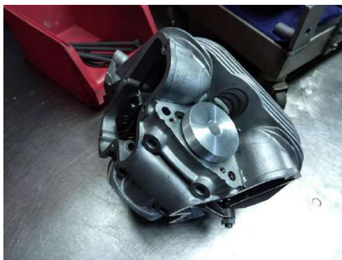
Le palier étant parti en polissage, usinage d'un faux palier !
