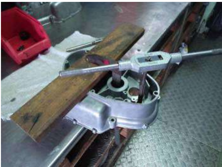
Reprise du carter en usinage !
