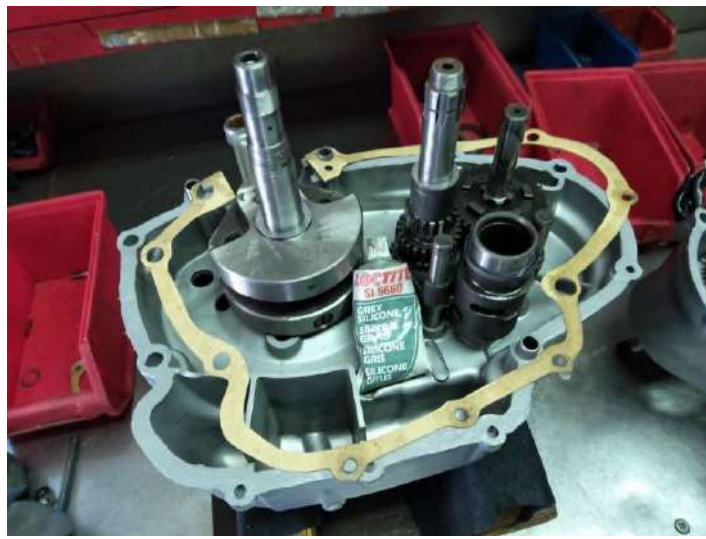
Joint papier de 0.50 monté à la pâte.
