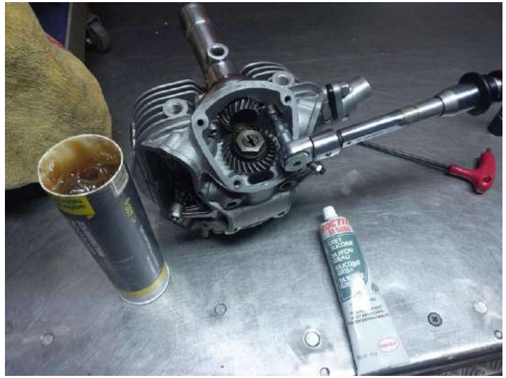
Remontage du palier d'arbre à cames : joint papier de 0.45 + pâte à joint, BTR inox M6x15 graissées, serrage 1Kg ! Remontage de la colonne : joint papier de 0.80 + pâte à joint, BTR inox M6x25 graissées, serrage 1Kg !
