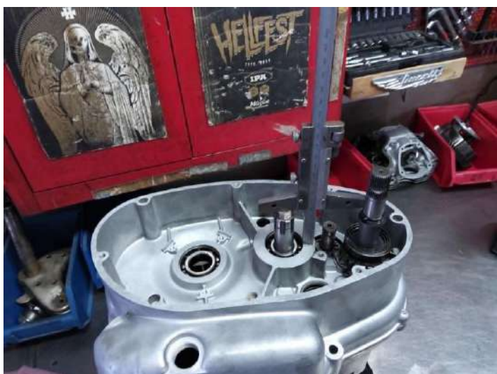
Contrôle et calage des jeux latéraux : Arbre primaire de boîte : trouvé 1.12, mis 0.50. Arbre secondaire de boîte : trouvé 0.42 : gardé ! Barillet de sélection : trouvé 0.79, mis 0.60 !
