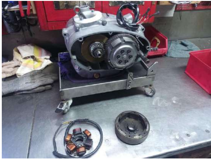
Essais de montage de l'alternateur offert par l'Espagnol !
