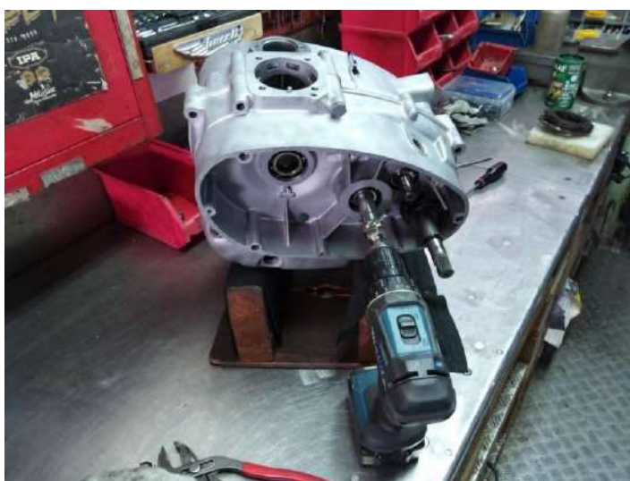
Re teste de passage des vitesses carters fermés sur joint papier de 0.70 !
