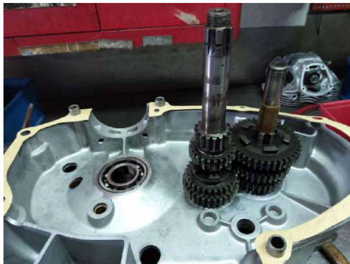
Départ de calage de la boîte : les pignon de 4 ème doivent être à la même hauteur !
