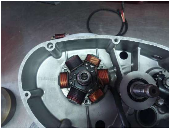
Les trois fixations du stator ne correspondent pas !
