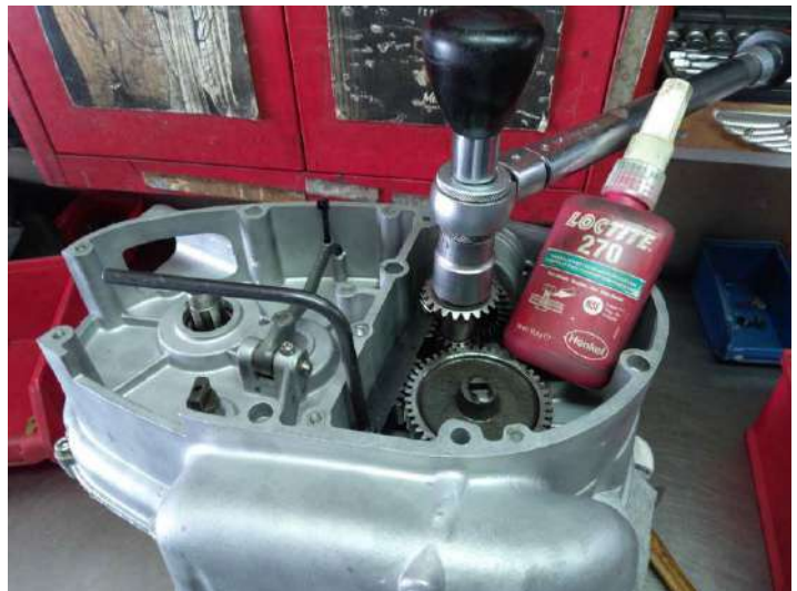
Calage du couple conique avec les pignons parfaitement alignés et un soupçon de jeu d'entre dents réglé à l'oreille !
