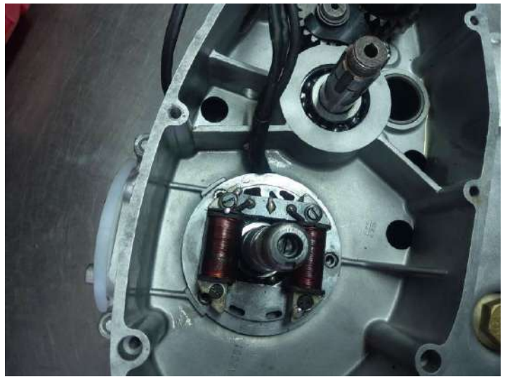
Les trois fixations du stator ne correspondent pas !
