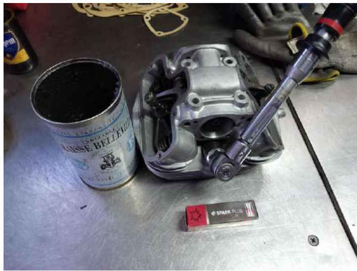
Teste de serrage à 2Kg avec graisse belleville.
