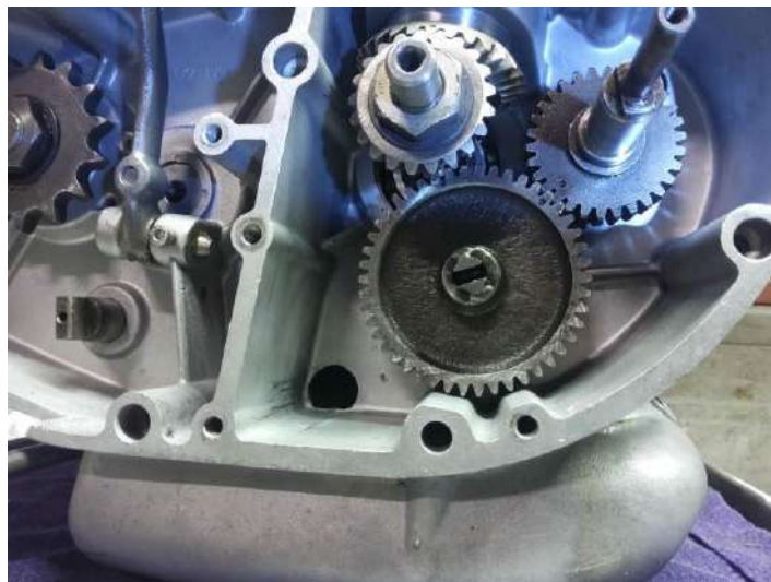
Tous les pignons mis point à point !
