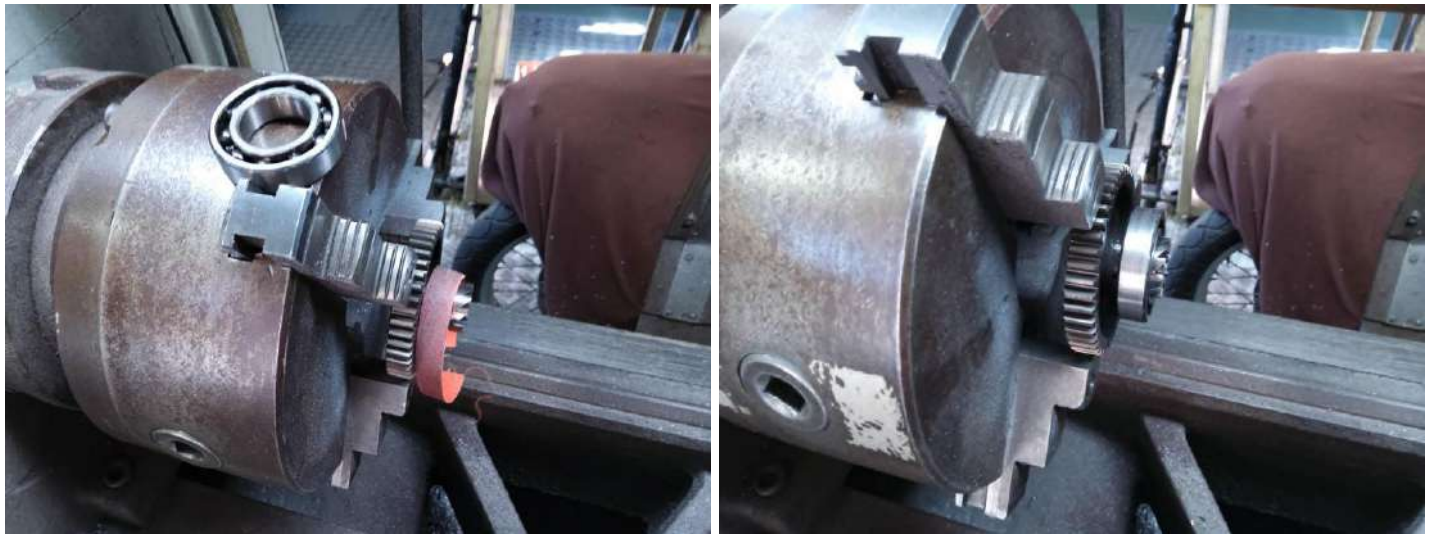
Toilage du pignon de première d'arbre secondaire qui sert au système kick, le roulement a été difficile à extraire au démontage.
