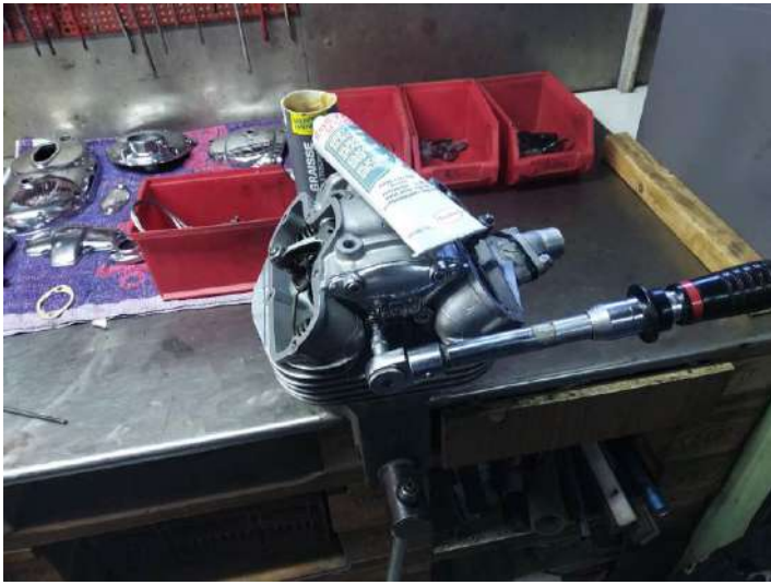
Remontage du palier d'arbre à cames : joint papier de 0.45 + pâte à joint, BTR inox M6x15 graissées, serrage 1Kg ! Remontage de la colonne : joint papier de 0.80 + pâte à joint, BTR inox M6x25 graissées, serrage 1Kg !
