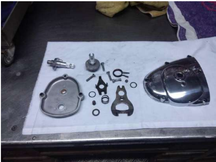
Remontage du boîtier de pré sélection.
