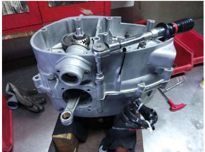
Fermeture des carters. 5 BTR inox M6x25 graissées, serrage : 1Kg. 2 goujons M8 graissés, serrage : 2.5Kg.
