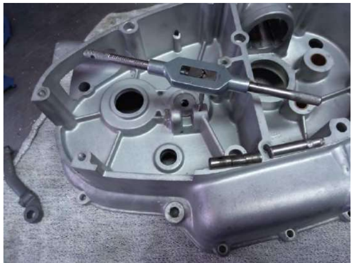
Microbillage et peinture du levier ! Axe bouffé et changé par un en inox verrouillé par une BTR M4.
