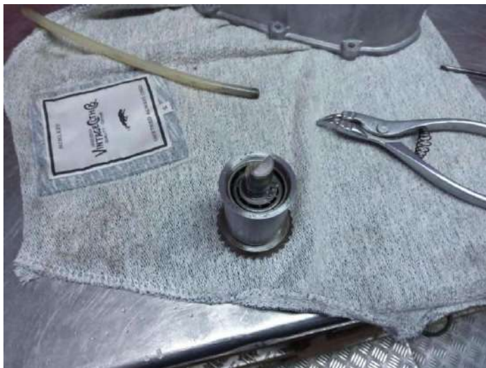
Toilage du petit arbre. Montage avec un circlips Ø145 neuf et calage avec zéro jeu vertical entre les roulements !
