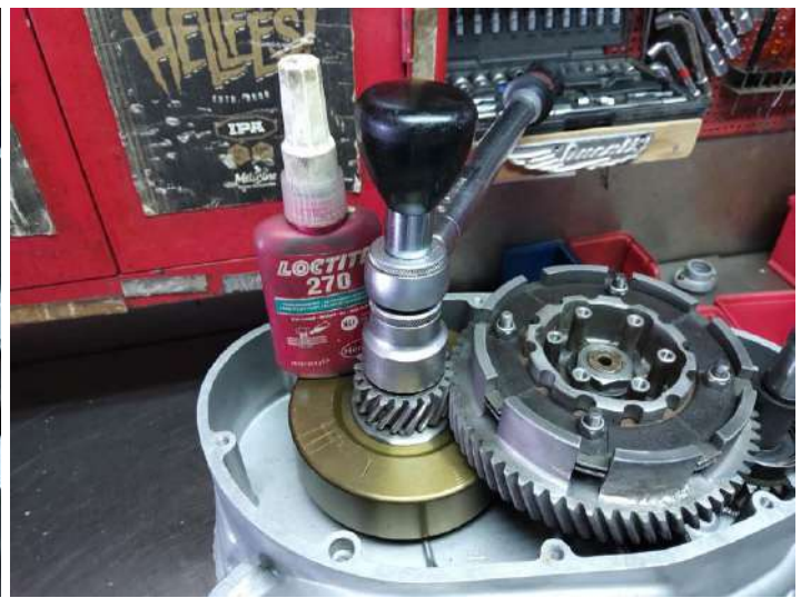
Clavette demi lune de 4 neuve. Serrage : 9Kg sur rondelle belleville + frein filet fort.
