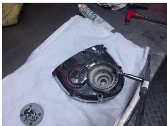
Décrochage de la pâte à polir dans les lamages.
