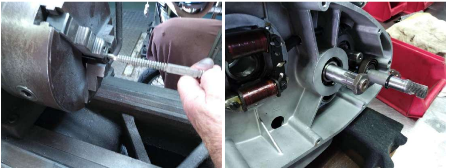
Reprise au peigne du taraudage de l'écrou de cloche d'embrayage !
