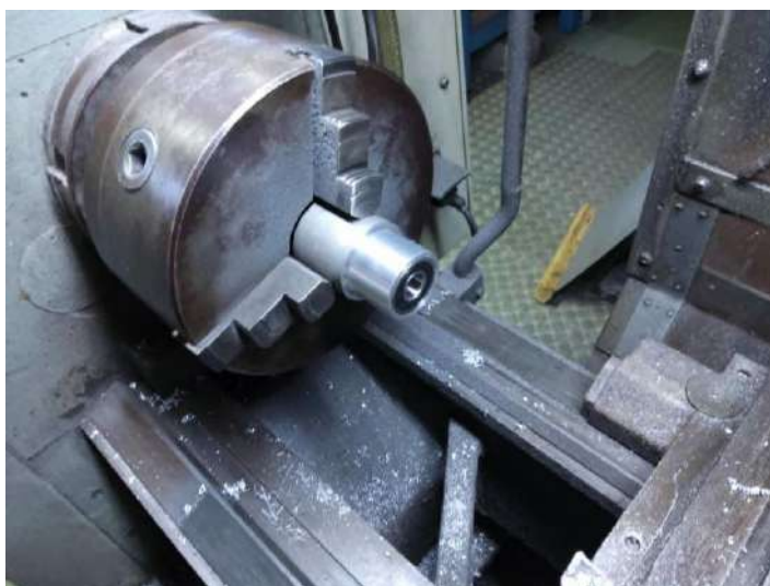
Le palier étant parti en polissage, usinage d'un faux palier !
