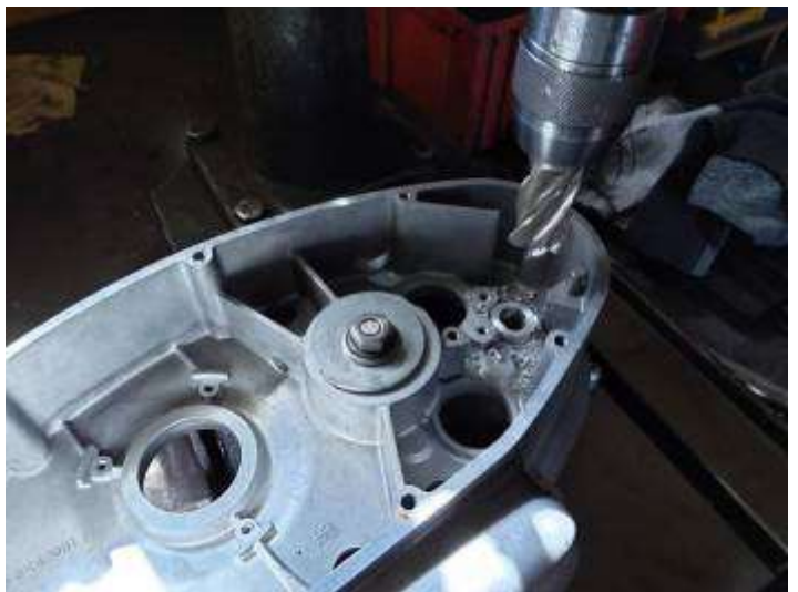
Reprise du carter en usinage !
