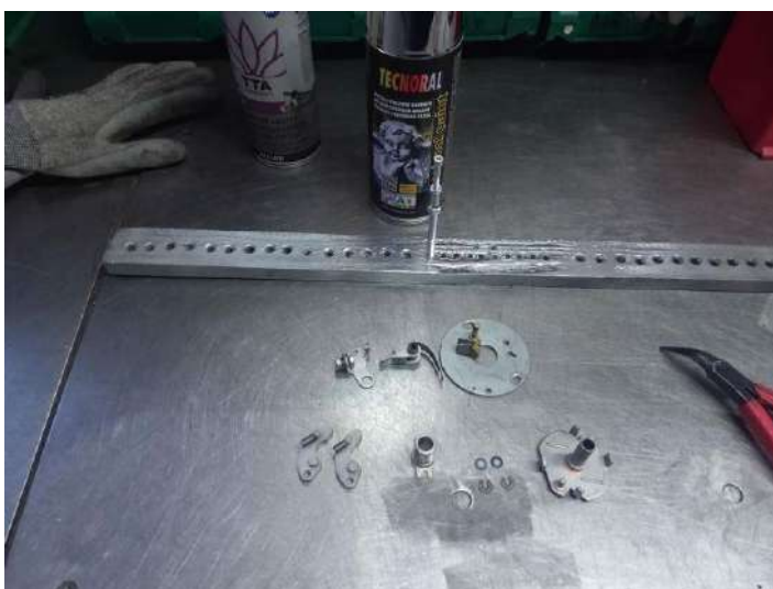
Démontage au dégrissant. Tout microbillé et peinture pour la vis de capot d'allumage !
