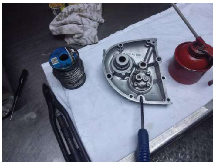
Remontage de la pompe à huile, teste de liberté de rotation et sécurisé les vis au fil à freiner !
