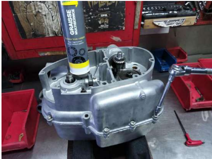
Fermeture des carters. 5 BTR inox M6x25 graissées, serrage : 1Kg. 2 goujons M8 graissés, serrage : 2.5Kg.
