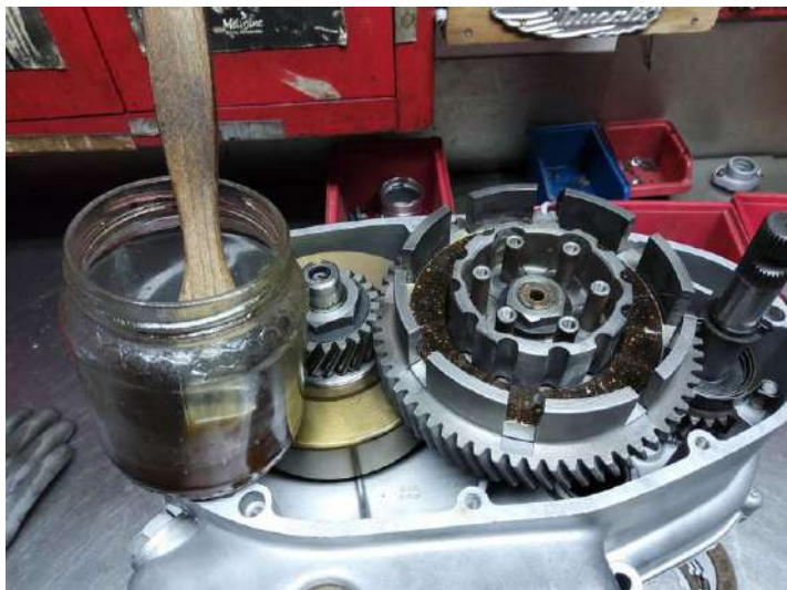
Les cinq disques garnis imbibés à l'huile moteur. Serrage des BTR M5x16 : 0.8Kg + frein filet faible.
