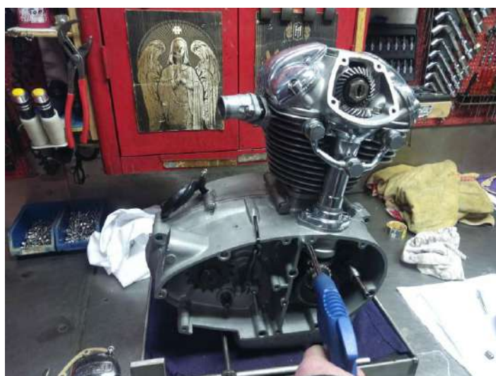
Vérification du circuit de montée d'huile vers l'arbre à cames !
