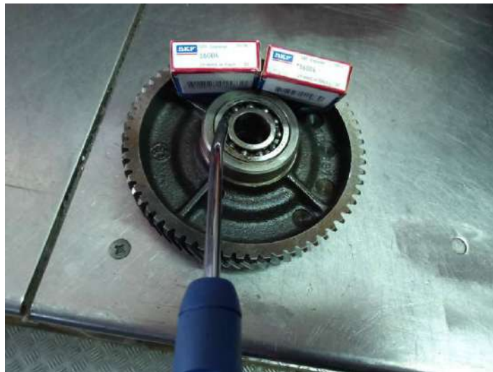
Les roulements 1604 de la cloche d'embrayage ne tournent pas librement : à changer !
