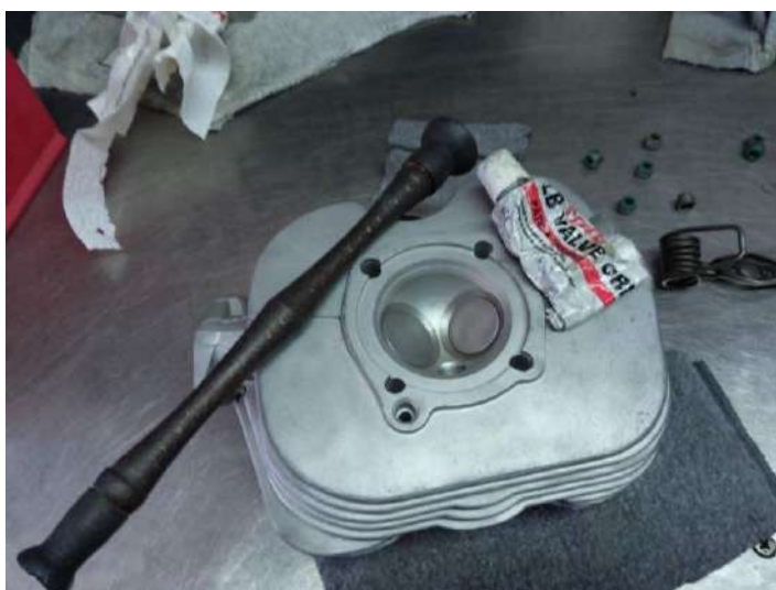
Toilage de la queue de soupape pour effacer la bavure provoquée par les clavettes demi lunes de verrouillage ! Rodage des sièges acier !
