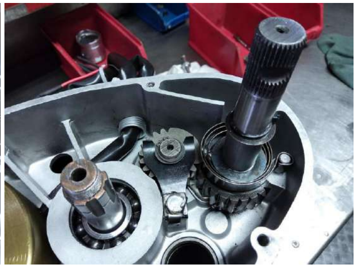
Montage de la crépine à l'oléoétanche. Remontage complet du système kick.
