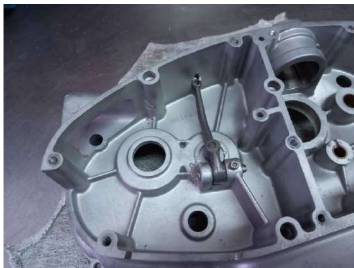
Microbillage et peinture du levier ! Axe bouffé et changé par un en inox verrouillé par une BTR M4.
