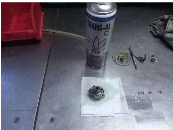
Démontage au dégrissant. Tout microbillé et peinture pour la vis de capot d'allumage !
