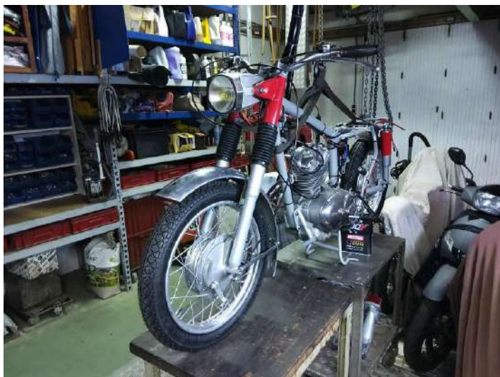
Remontage du train AV avec fixation du garde-boue !
