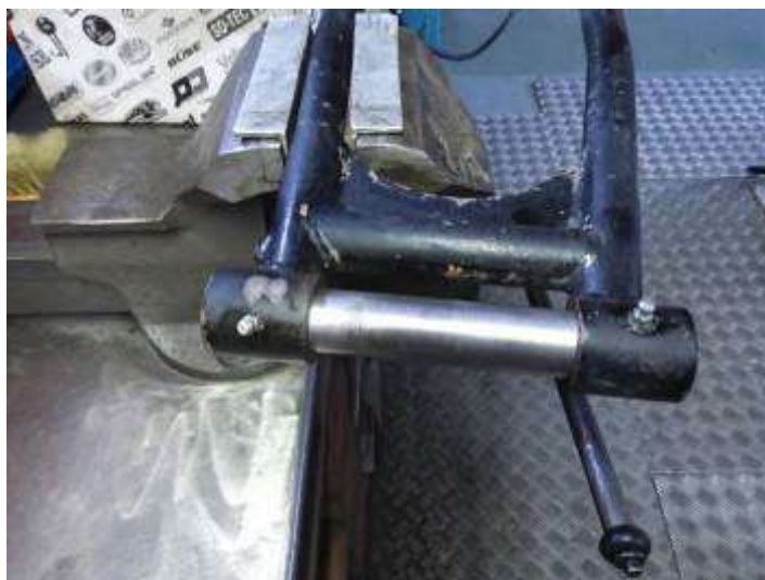
Dégraissage et toilage de l'axe de bras oscillant !
