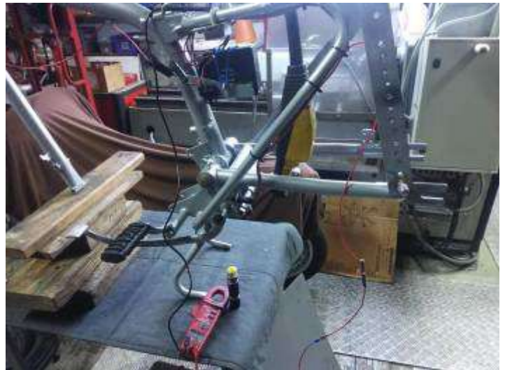
Teste du contacteur de feu stop : OK ! Mise en place avec ressort et re teste : OK !
