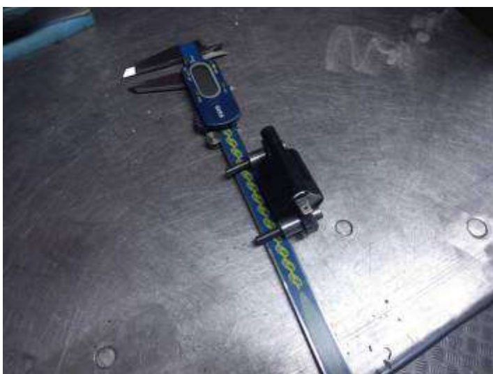
Usinage de deux petites entretoise 12x6x12 pour fixation de la bobine d'allumage.
