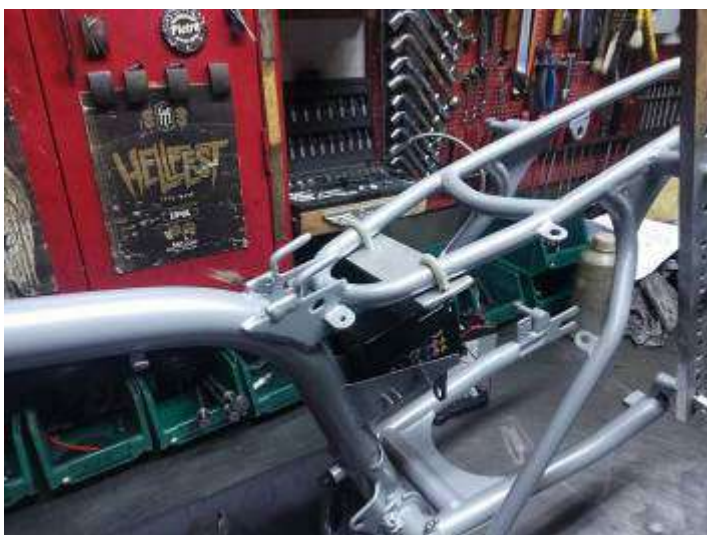
Pose d'une gaine pour protéger la peinture !
