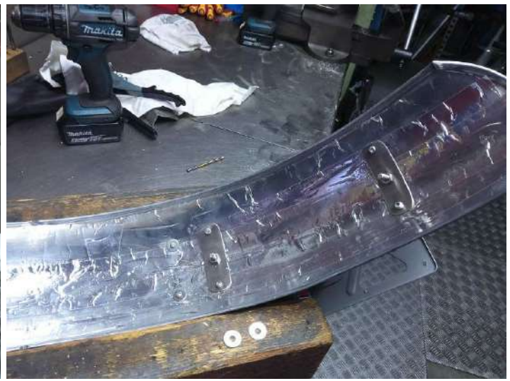
Fixation difficile du support de plaque et feu AR ! Renforts intérieurs en tôle inox de 2mm !
