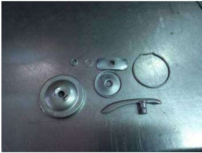
Passage de la brosse tournante, microbillage et peinture !
