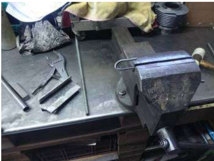
Préparation d'une tôle alu pour support du régulateur et masse principale ! Préparation de deux brides avec une tige filetée M6.
