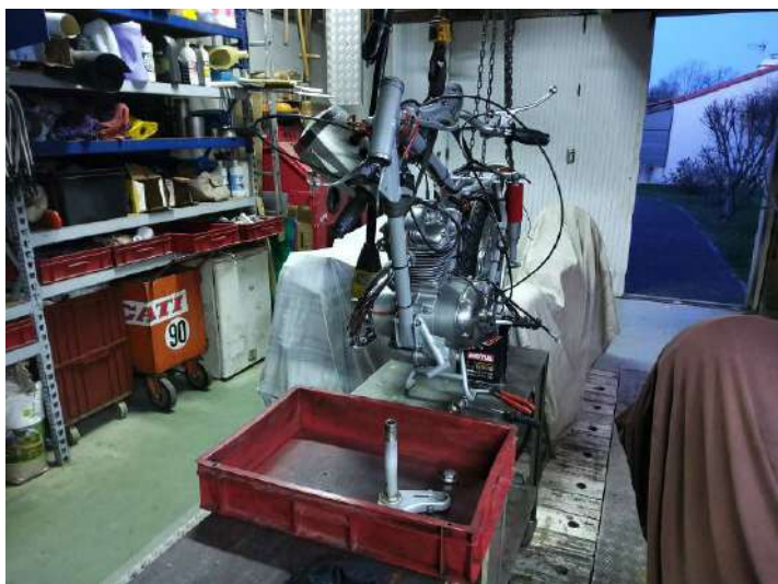
Démontage du train avant pour fixer la plaque d'identification avec quatre BTR inox M3.
