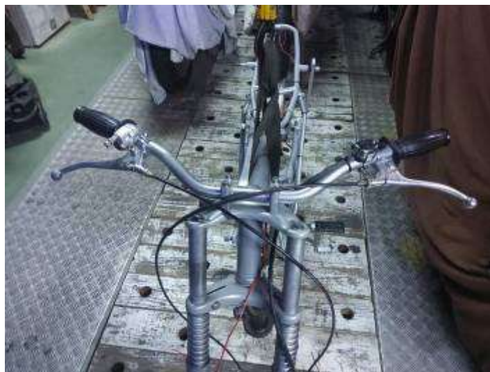
Le 28 novembre : levier d'embrayage à peine reçu, immédiatement mis en place !
