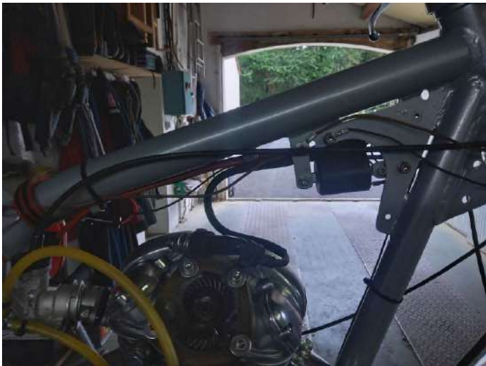
Deux petites pattes inox pour fixer la bobine.
