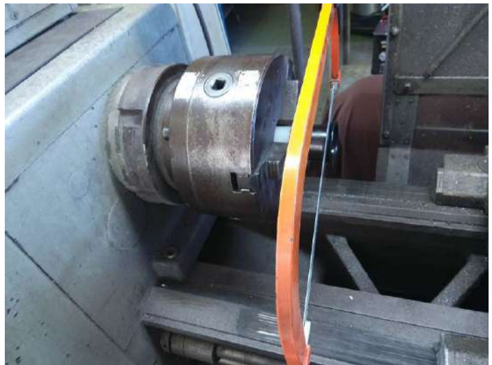
Découpe de la tulipe de cornet de carbu pour le rentrer dans le coffre boîte à air !
