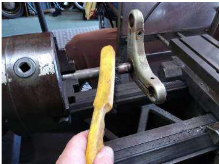
Dégraissage et décrassage !
