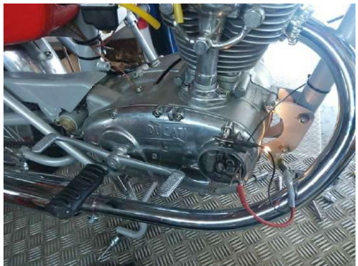
Calage de l'allumage à 18° avant le point mort en initial pour obtenir 40° en pleine avance !
