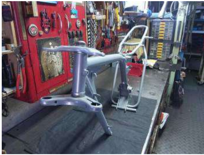
Remontage de la colonne de direction.
