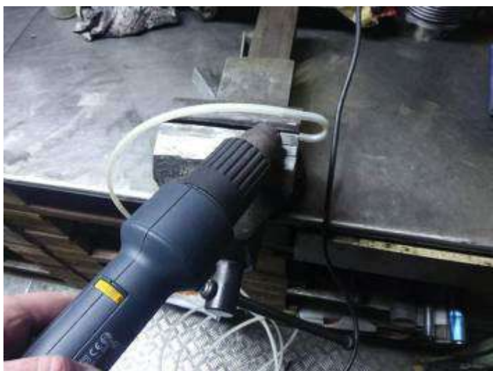
Pose d'une gaine pour protéger la peinture !
