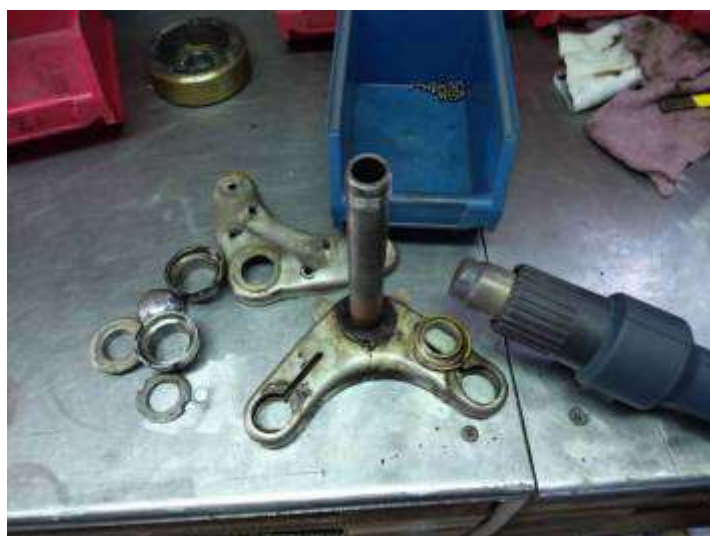
Extraction difficile à chaud de la coupelle inférieure ! Tout mis à tremper dans du dégraissant !
