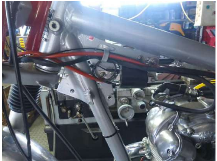
Deux petites pattes inox pour fixer la bobine.
