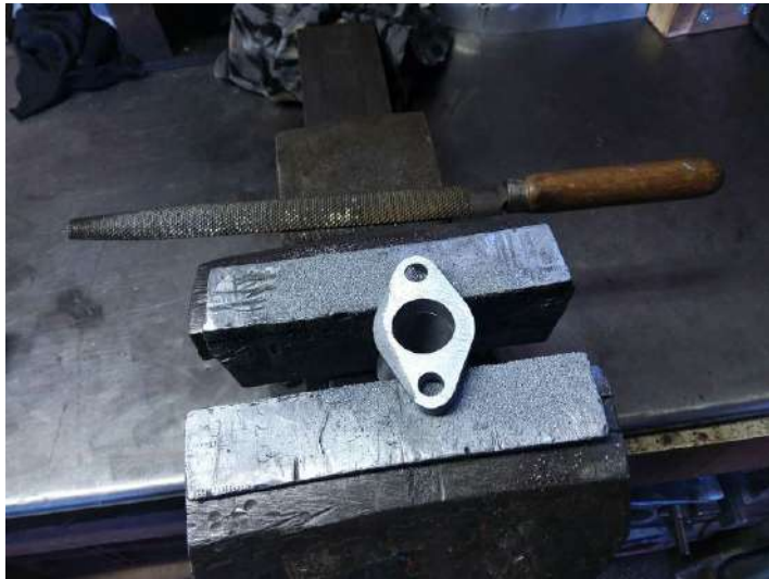
Reprise de l'inclinaison du carbu par la pipe d'admission. Contrôle de la planéité !
