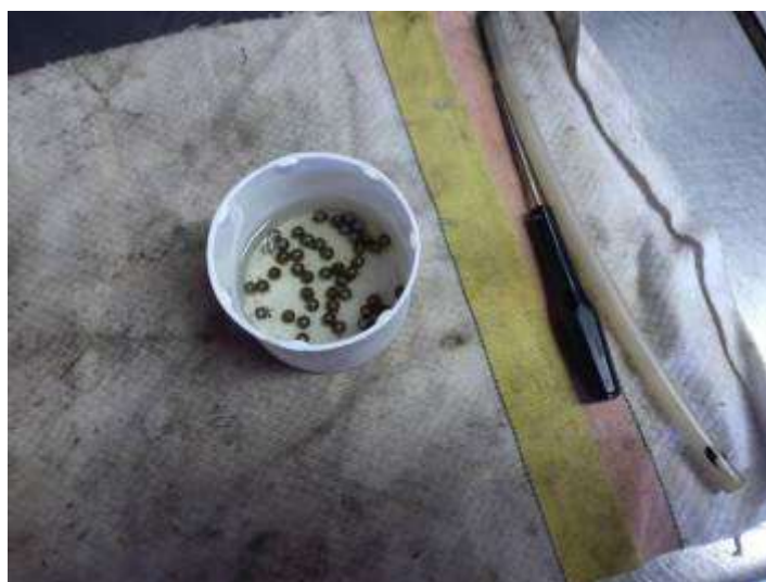
48 Billes de direction Ø4.72 à tremper dans du dégraissant !
