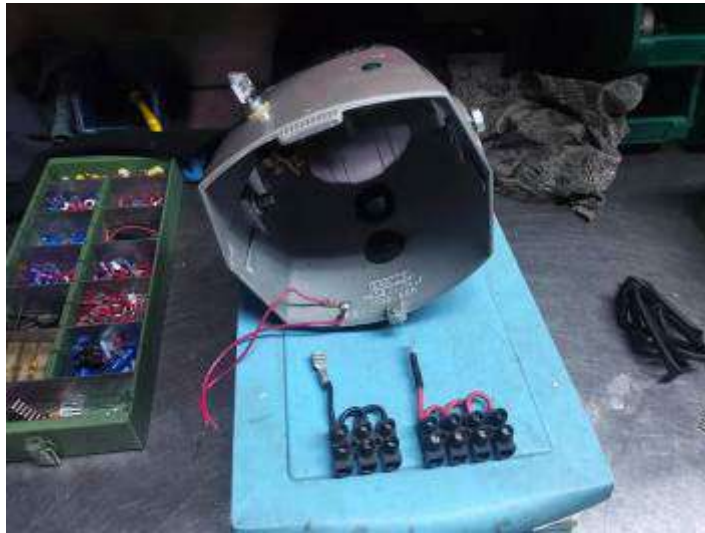
Début de préparation du circuit électrique interne au phare.
