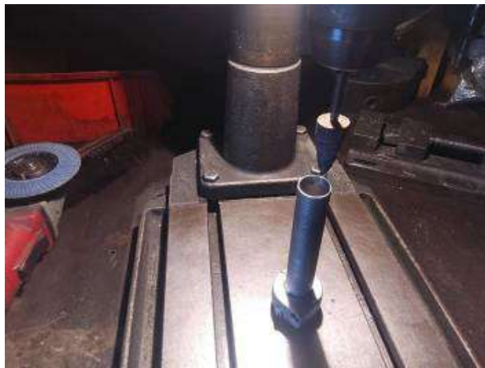
Le bout de la poignée bloque sur le guidon sans doute dû à une chute : ébavurage !
