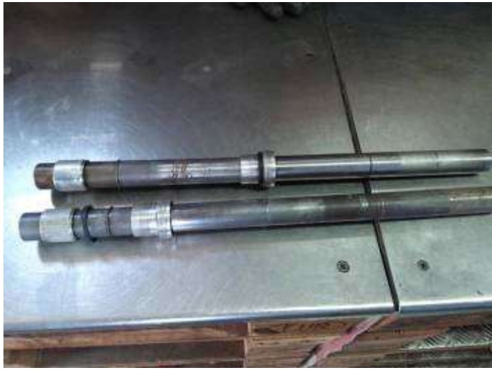
Toilage, microbillage et peinture des tubes de fourche !
