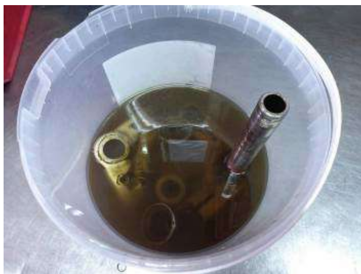
Extraction difficile à chaud de la coupelle inférieure ! Tout mis à tremper dans du dégraissant !
