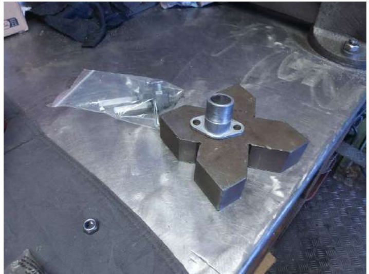
Reprise de l'inclinaison du carbu par la pipe d'admission. Contrôle de la planéité !
