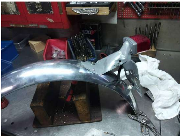
Fixation difficile du support de plaque et feu AR ! Renforts intérieurs en tôle inox de 2mm !
