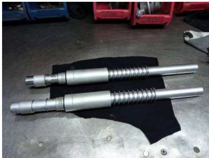
Reprise au peigne des filetages au pas de 100 !
