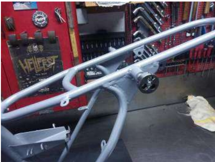
Passage de la filière M10x100. Remontage du bras oscillant, axe bien graissé, serrage des BTR M6x40 graissées : 1Kg.
