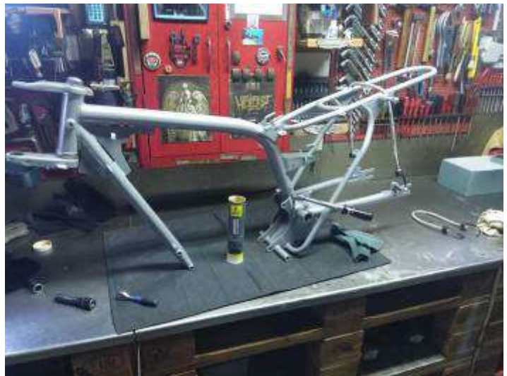
Passage de la filière M10x100. Remontage du bras oscillant, axe bien graissé, serrage des BTR M6x40 graissées : 1Kg.
