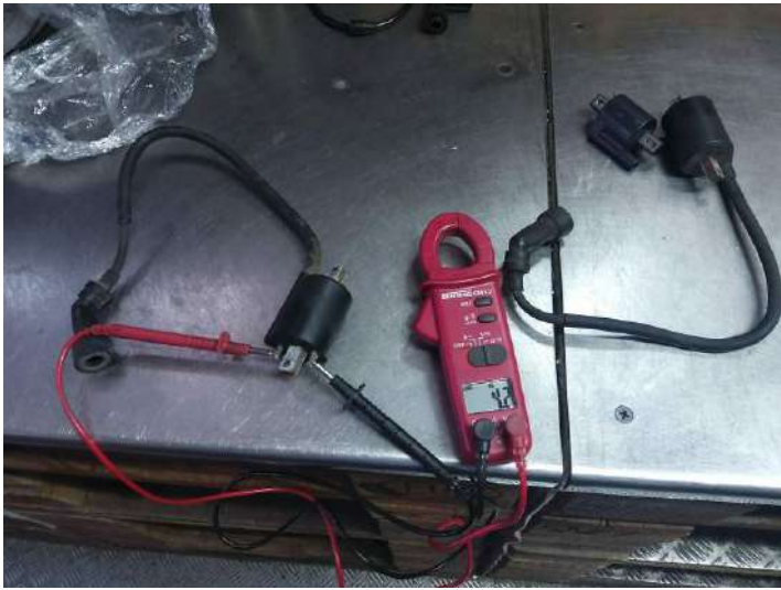
Nouvelle bobine de Yamaha BT 1100 Bulldog. Résistance : 4.2 Ohms. Microbillage des cosses et teste de qualité d'étincelle : impeccable !
