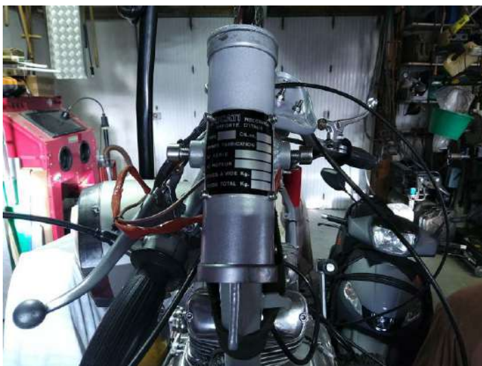
Démontage du train avant pour fixer la plaque d'identification avec quatre BTR inox M3.
