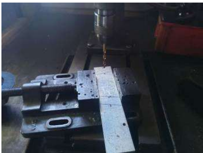
Préparation d'une tôle alu pour support du régulateur et masse principale ! Préparation de deux brides avec une tige filetée M6.
