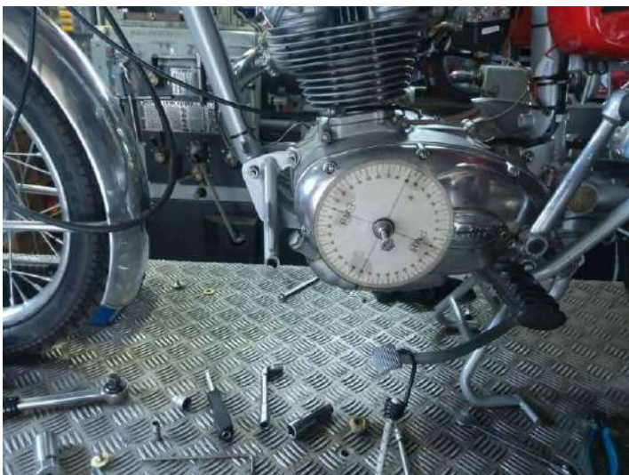
Calage de l'allumage à 18° avant le point mort en initial pour obtenir 40° en pleine avance !
