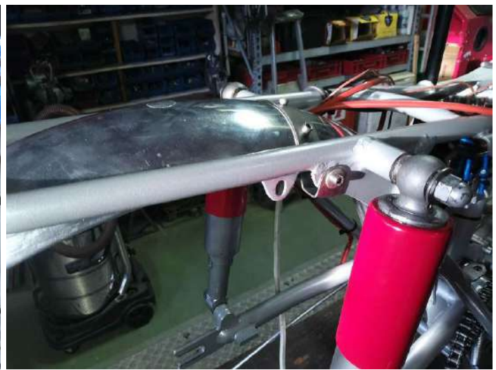
Fixation difficile du support de plaque et feu AR ! Renforts intérieurs en tôle inox de 2mm !
