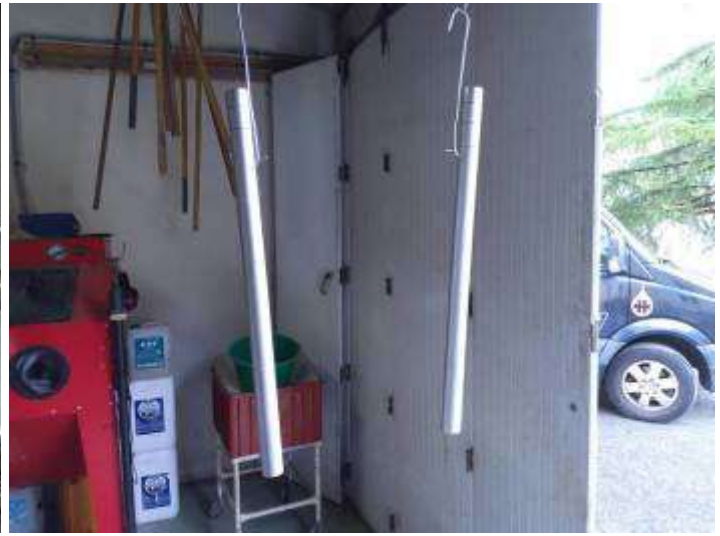
Toilage, microbillage et peinture des tubes de fourche !
