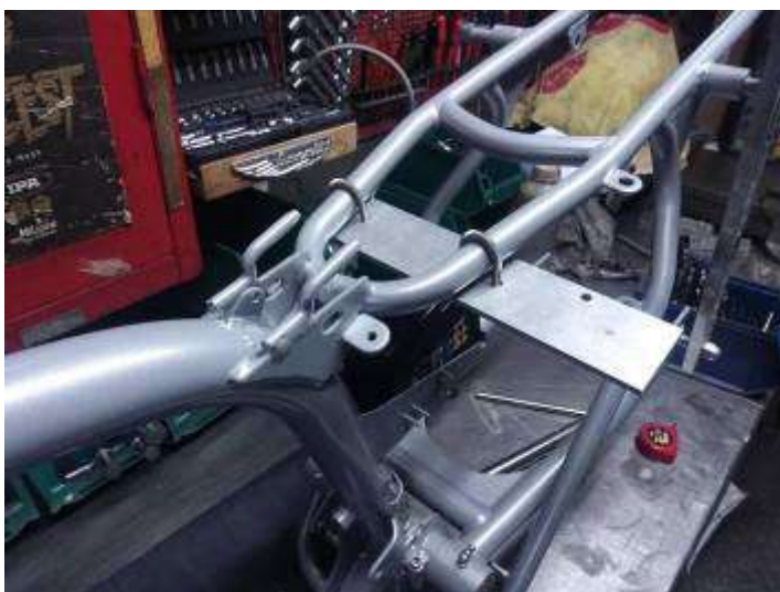
Préparation d'une tôle alu pour support du régulateur et masse principale ! Préparation de deux brides avec une tige filetée M6.
