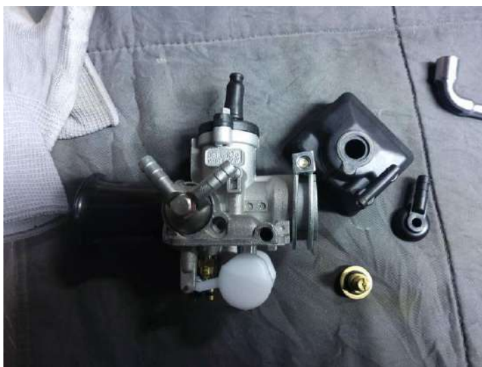
Réception du carbu neuf Dellorto PHBL22. Gicleur principal de 100, ralenti de 50. Montage de la double arrivée.
