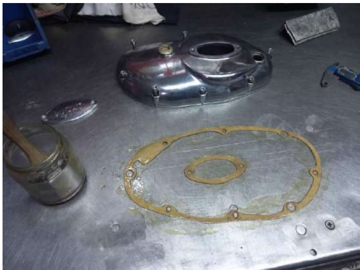
Joint papier de 0.60 passés à l'huile moteur. Serrage des BTR inox M6 graissées : 1Kg !
