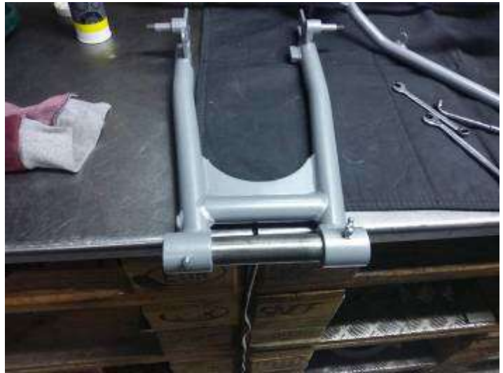
Passage de l'âlesoir Ø29 pour retirer la peinture. Montage des deux graisseurs de bagues du bras oscillant !
