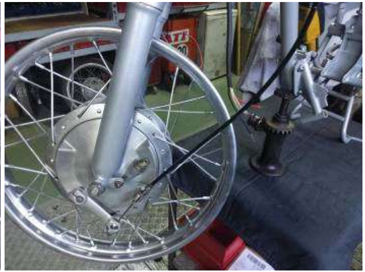
Microbillage des éléments d'embout de câble. Pré réglage du frein.
