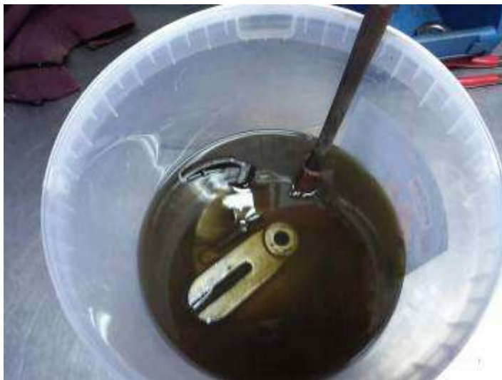
Dégraissage et décrassage !
