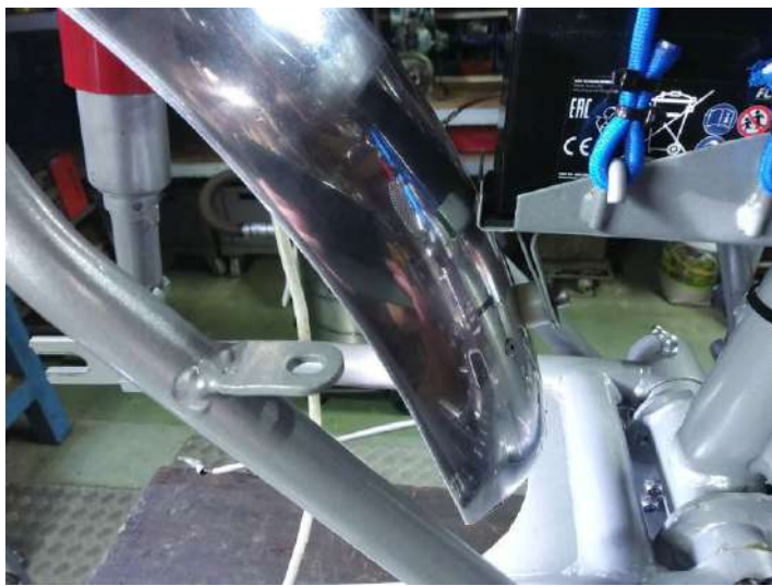
Fixation difficile du support de plaque et feu AR ! Renforts intérieurs en tôle inox de 2mm !
