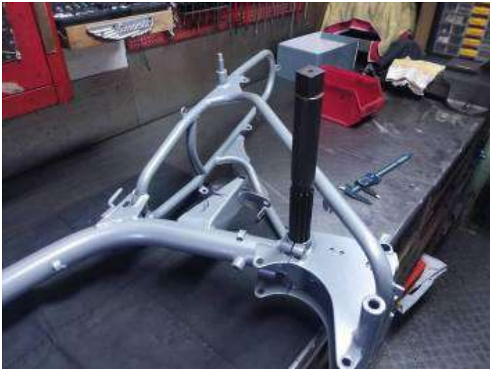
Passage de l'âlesoir Ø29 pour retirer la peinture. Montage des deux graisseurs de bagues du bras oscillant !
