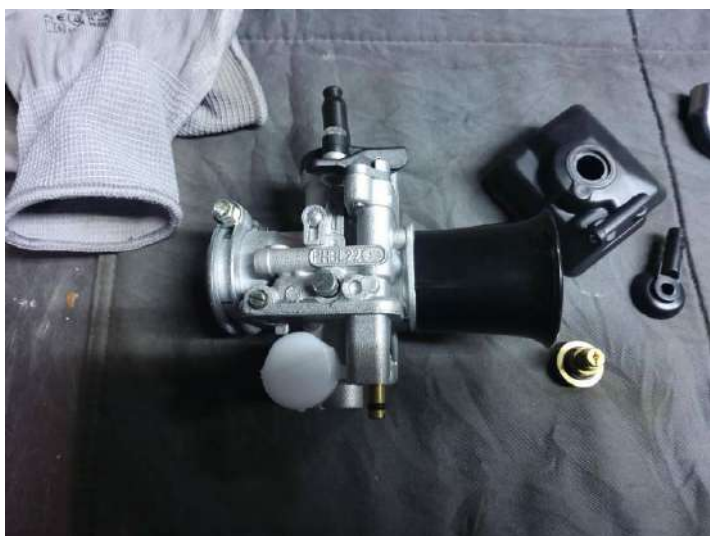
Réception du carbu neuf Dellorto PHBL22. Gicleur principal de 100, ralenti de 50. Montage de la double arrivée.
