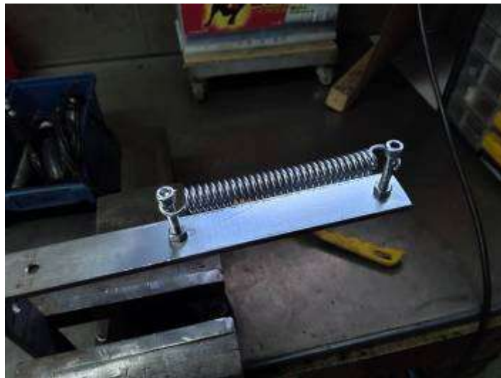
Ressort de béquille : mis en tension, brossage, microbillage et peinture !
