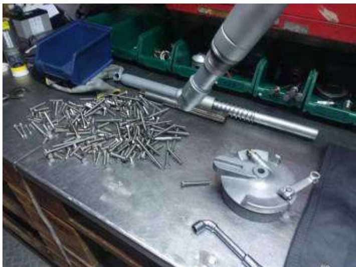
Montage à blanc pour définir la longueur des vis TH M8 inox !
