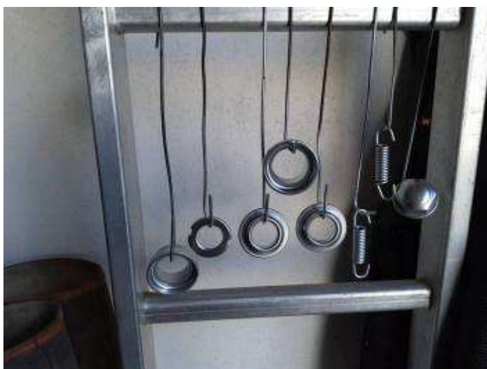
Microbillage et peinture des pièces acier pour bloquer l'oxydation !
