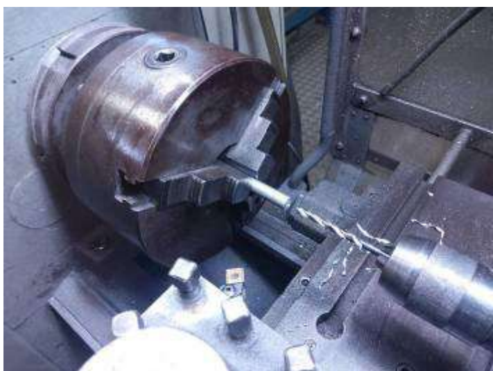
Usinage de deux petites entretoise 12x6x12 pour fixation de la bobine d'allumage.
