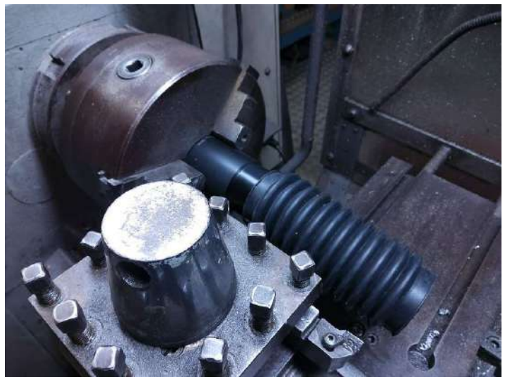
Usinage de deux bagues 50x45x20 en Ertalyste pour compensation de \varnothing et fixation des soufflets !
