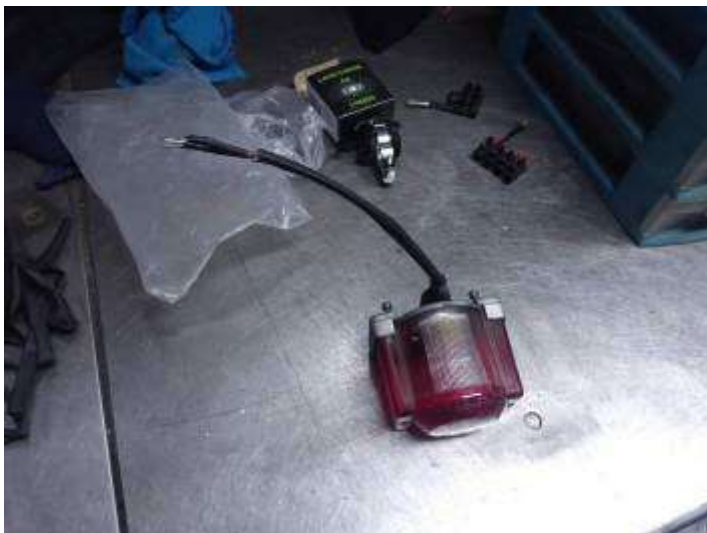
Feu AR : nettoyage, microbillage et circuit électrique !
