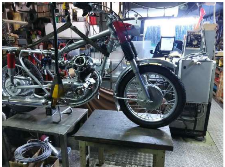
Remontage du train AV avec fixation du garde-boue !
