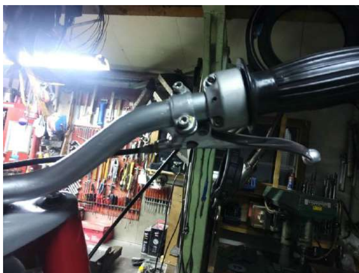
Pose d'une BTR anti rotation sur la poignée d'accélérateur. Trouvé le bon réglage pour que le boisseau de carbu se ferme rapidement.
