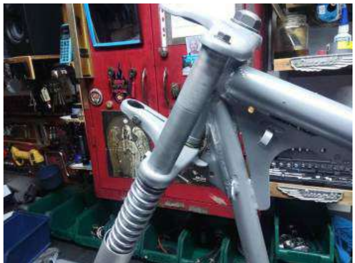
Montage à blanc pour définir la longueur des vis TH M8 inox !
