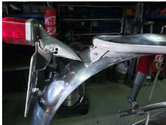
Vu le nombre de fixations, le garde boue AR ne devrait ni bouger ni se fendre !
