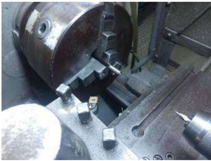
Usinage en inox d'une pièce manquante pour régler la tension de câble !
