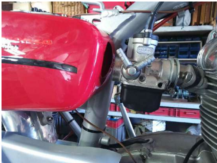
Découpe de la tulipe de cornet de carbu pour le rentrer dans le coffre boîte à air !
