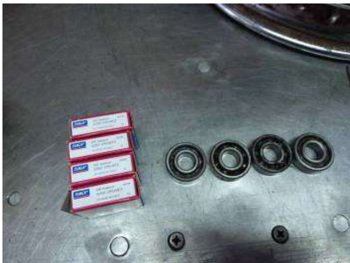
Changement des roulements de roues. Toilage de l'axe de roue AR et reprise des filetages M15x125 !
