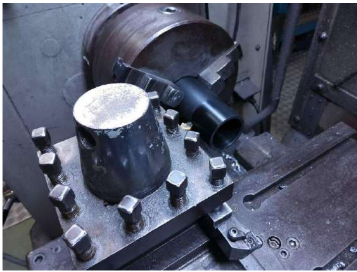
Usinage de deux bagues 50x45x20 en Ertalyste pour compensation de \varnothing et fixation des soufflets !
