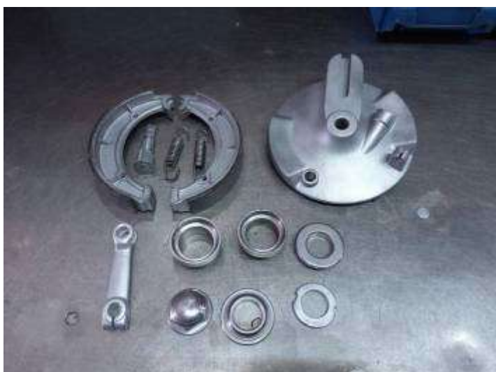
Microbillage et peinture des pièces acier pour bloquer l'oxydation !
