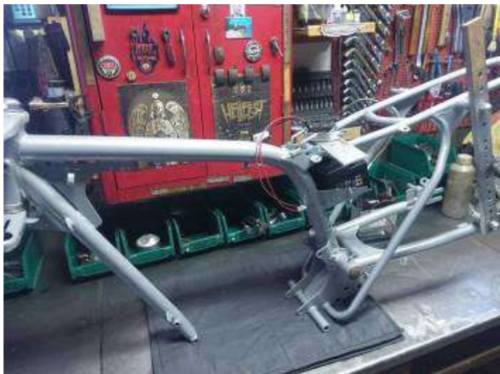
Préparation d'une tôle alu pour support du régulateur et masse principale ! Préparation de deux brides avec une tige filetée M6.
