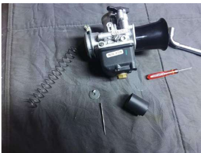
Hauteur d'aiguille au 3 ème cran en partant du haut.
