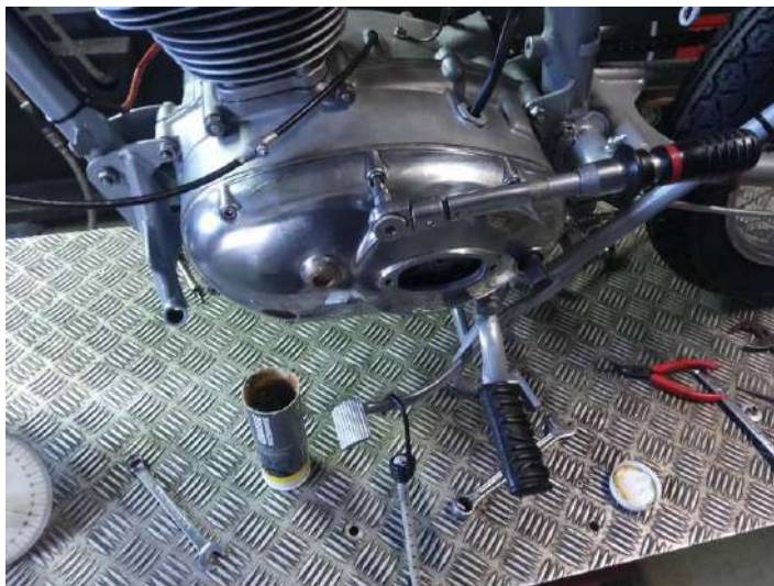
Joint papier de 0.60 passés à l'huile moteur. Serrage des BTR inox M6 graissées : 1Kg !
