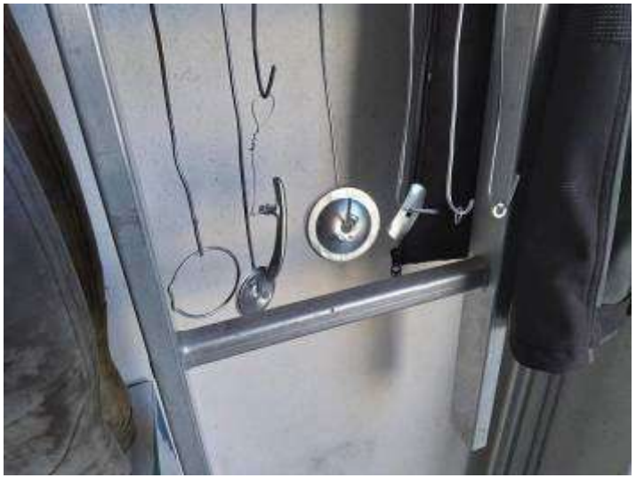
Passage de la brosse tournante, microbillage et peinture !
